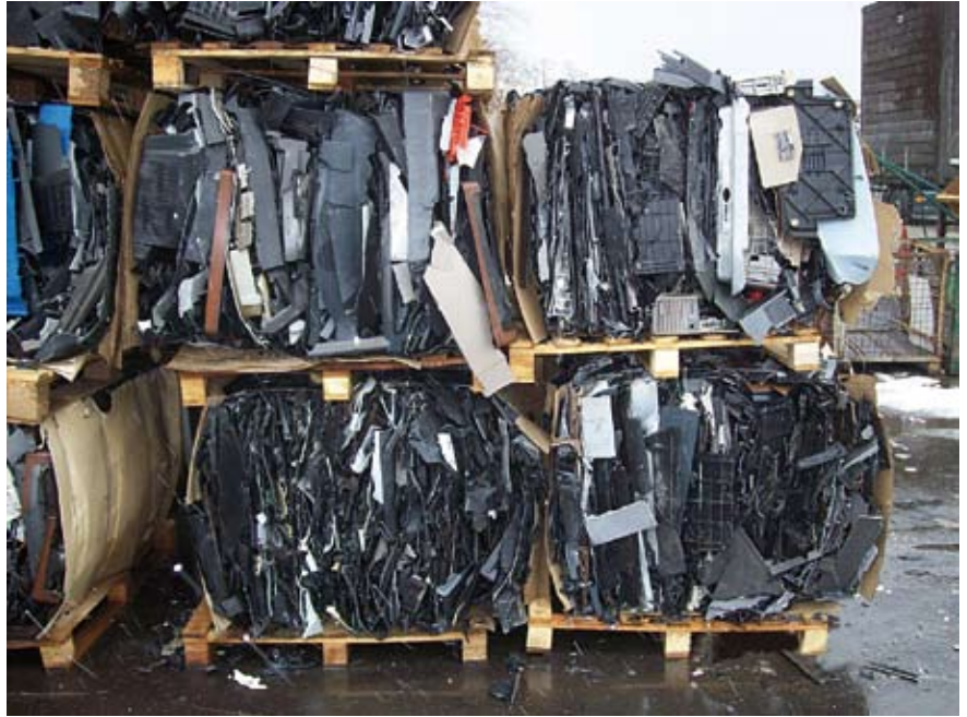
Die Vertikal-Ballenpresse V-Press 860 S von HSM komprimiert pro Tag 50 bis 60 Gehäuse zu einem Ballen von der Größe eines Kubikmeters und einem Gewicht von etwa 280 Kilogramm
