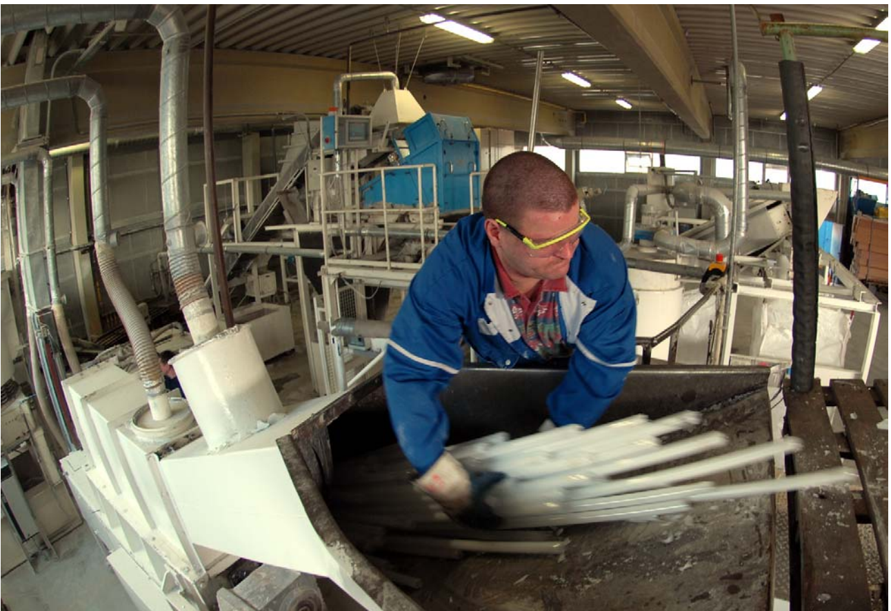
Im Shredder werden die Altlampen zerkleinert
