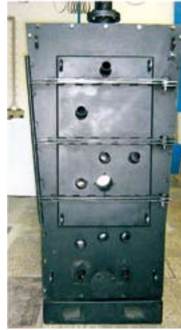
Der Wirbelfeuerungsofen der Firma Spanner RE2 GmbH
