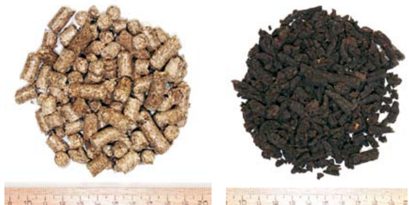
Erfolgreiche Verbrennungsversuche mit unterschiedlichen Materialien, darunter getrockneter Klärschlamm und Pellets aus Gerstenstroh
